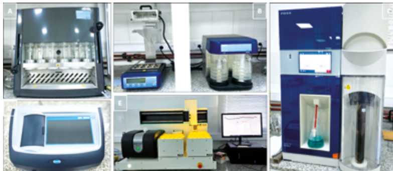
Figura 1: Equipos adquiridos a través de ARSET. A. Extractor de Materia Grasa -FOSS- B. Digestor de muestras para determinación de nitrógeno -FOSS- C. Destilador para determinación de nitrógeno -FOSS- D. Espectrofotómetro -HACH- E. RMN para determinar materia grasa de semillas -Spinlock-.
